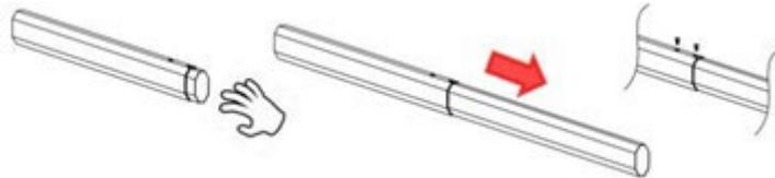
Figura 1 Conecte o braço principal com o braço secundário usando 2 parafusos.
